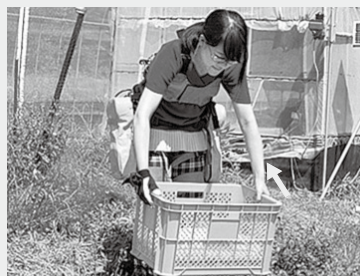
図3 持ち上げ動作をセンサが 感知してアシスト
