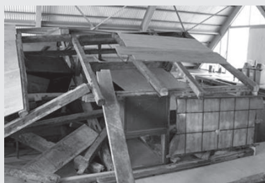
図3 倒壊家屋を想定した 実験施設（神戸）
