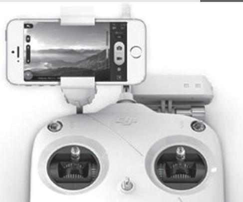
図3 DJI Phantom 2 Vision カメラ画像が手元で確認可能
