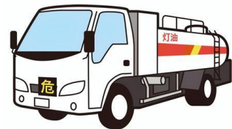
移動タンク貯蔵所 75
