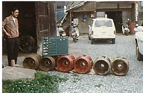
揚水機羽根車の摩耗
