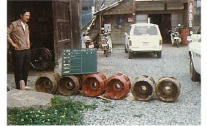
揚水機羽根車の摩耗
