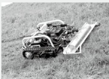
図5 傾斜40°の斜面でも除草可能
