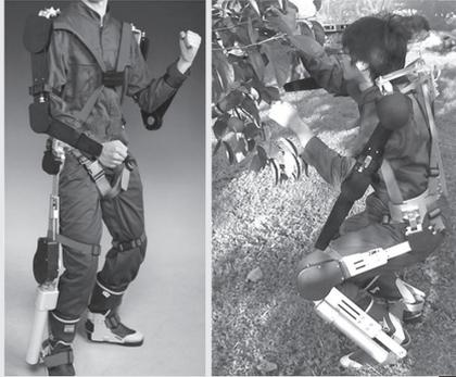
図1 農業用パワーアシストスーツ (東京農工大)
