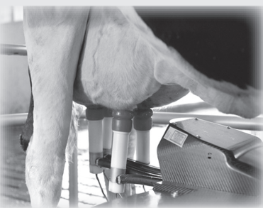
図3 搾乳ロボット先端部
