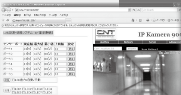
ネットワーク上のパソコンでカメラの映像や 車椅子からの信号を確認できる
