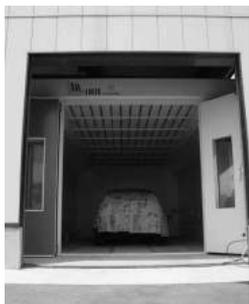
●塗装ブースは文字通り塗装する室。できるだけホコリを付けずに塗装～その場で乾燥できる。
