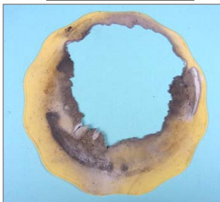
写真 1 焼損したマット
